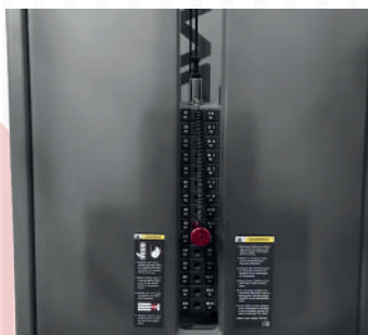
> Carenado protector para evitar accidentes mientras las placas están en movimiento. Protective fairing to avoid accidents while the plates are in movement.
